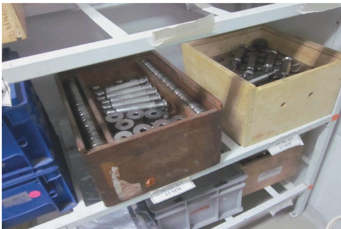
ITEM 2,185 - JOGOS DE PUNÇÕES E MOLDES EM INOX PARA COMPRIMIDO REDONDO 13 MM
