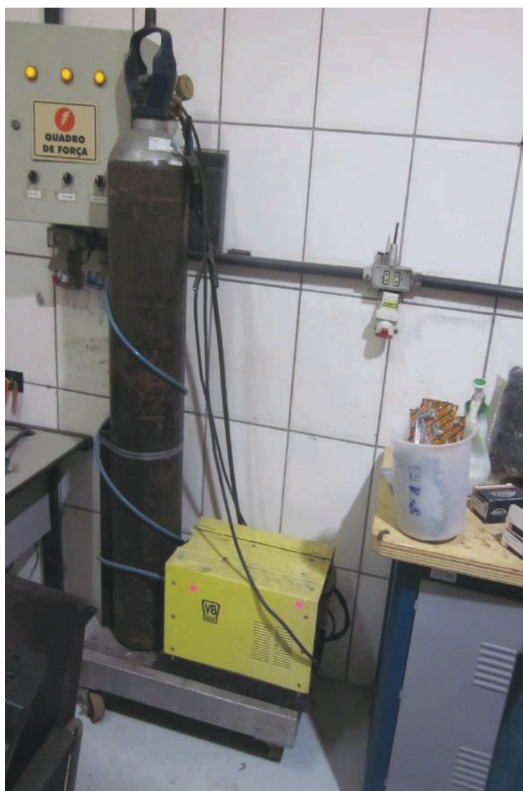
ITENS 2,242 / 2,243 - MÁQUINA DE SOLDA MIG V8 BRASIL 195E FLEX E CILINDRO DE MISTURA PARA SOLDA MIG HORTMIG 7 M3
