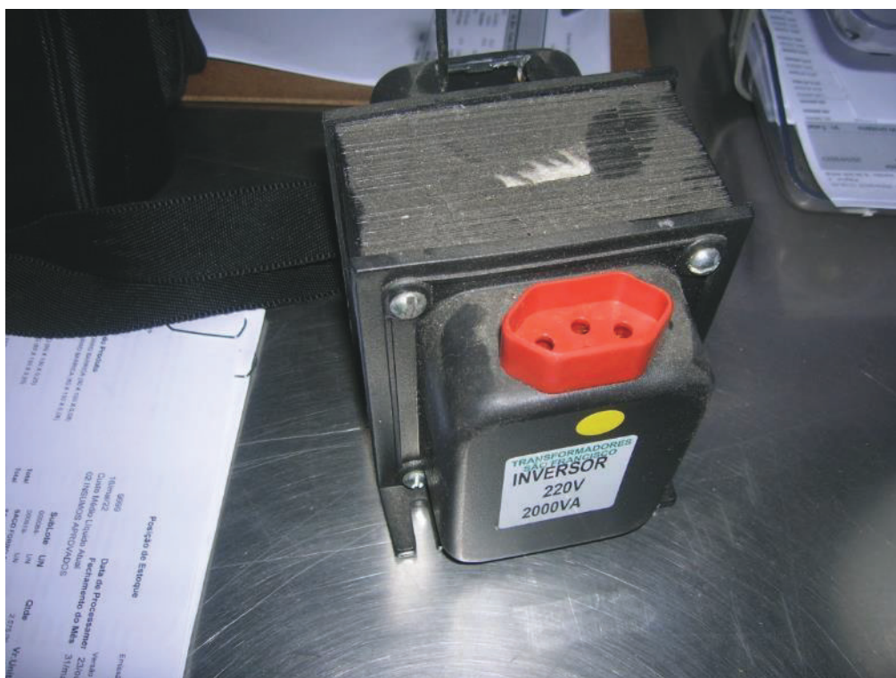
ITEM 1,030 - AUTOTRANSFORMADOR 110/220 V INVERSOR 2 KVA
