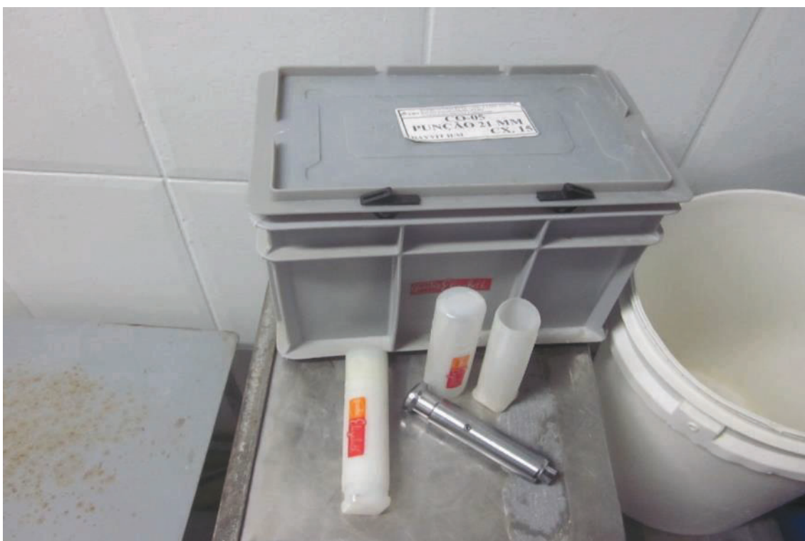
ITEM 2,187 - JOGO DE PUNÇÕES EM INOX PADE ELIZABETH PARA COMPRIMIDO OVAL 21 MM
