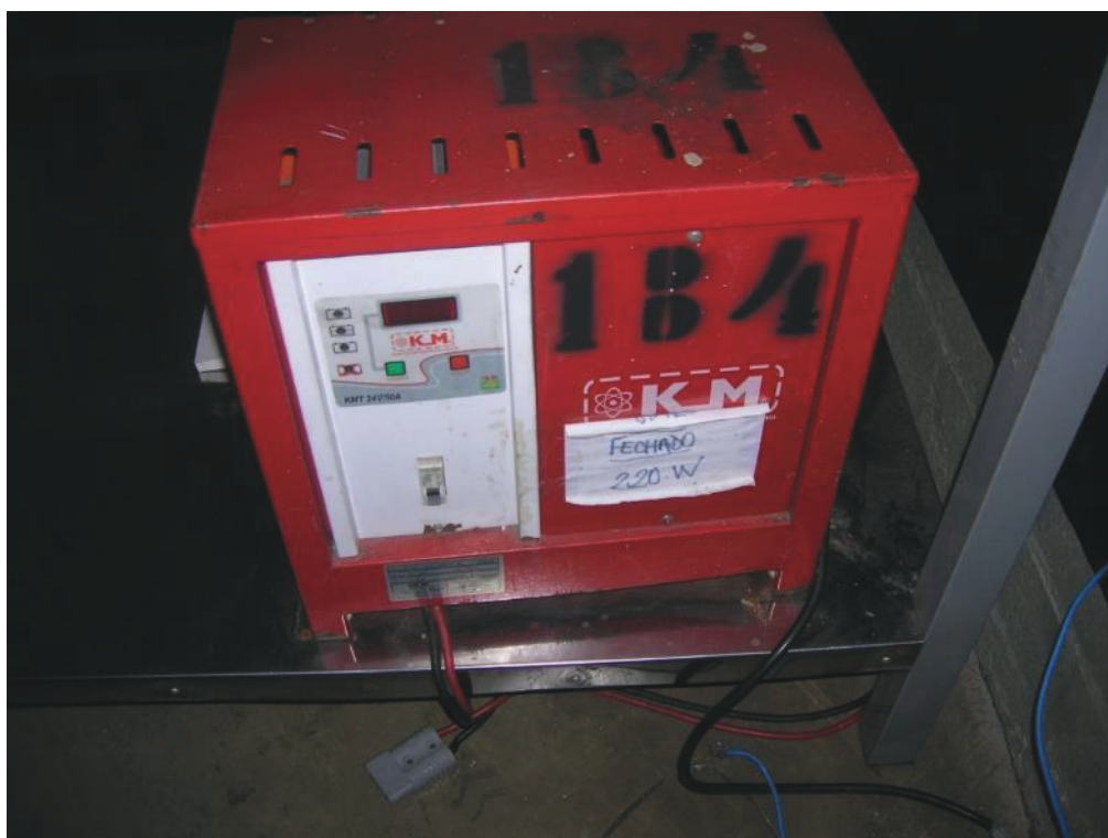
ITEM 1,023 - CARREGADOR DE BATERIAS KMT 24V/50A 220 V / 29,4 VCC
