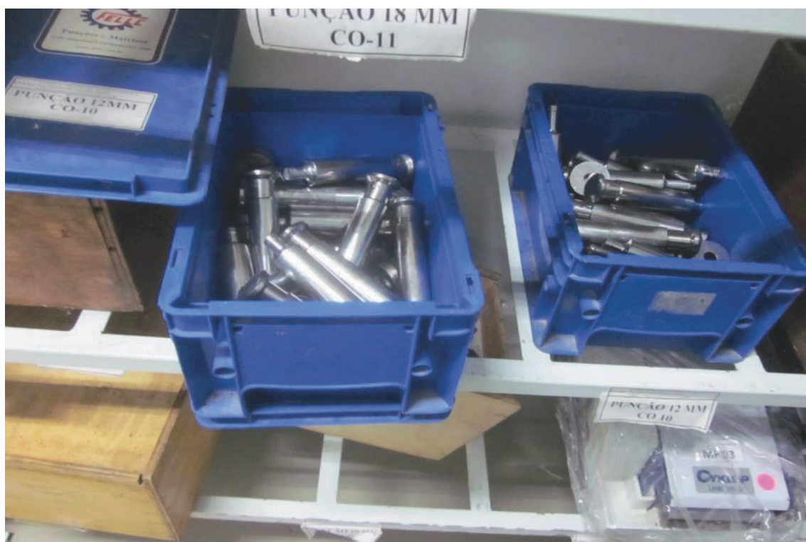
ITENS 2,183 / 2,184 - JOGOS DE PUNÇÕES E MOLDES EM INOX PARA COMPRIMIDO REDONDO 12 MM (CO-10)
