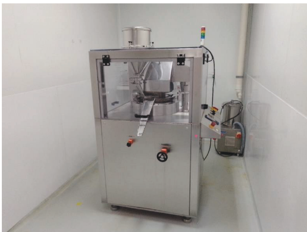
ITEM 1,540 - MÁQUINA DE COMPRESSÃO ROTATIVA NEUBERGER MN20F
