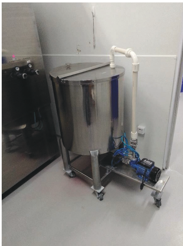
ITEM 1,381 - CONJUNTO MISTURADOR COMPOSTO DE TANQUE EM INOX
