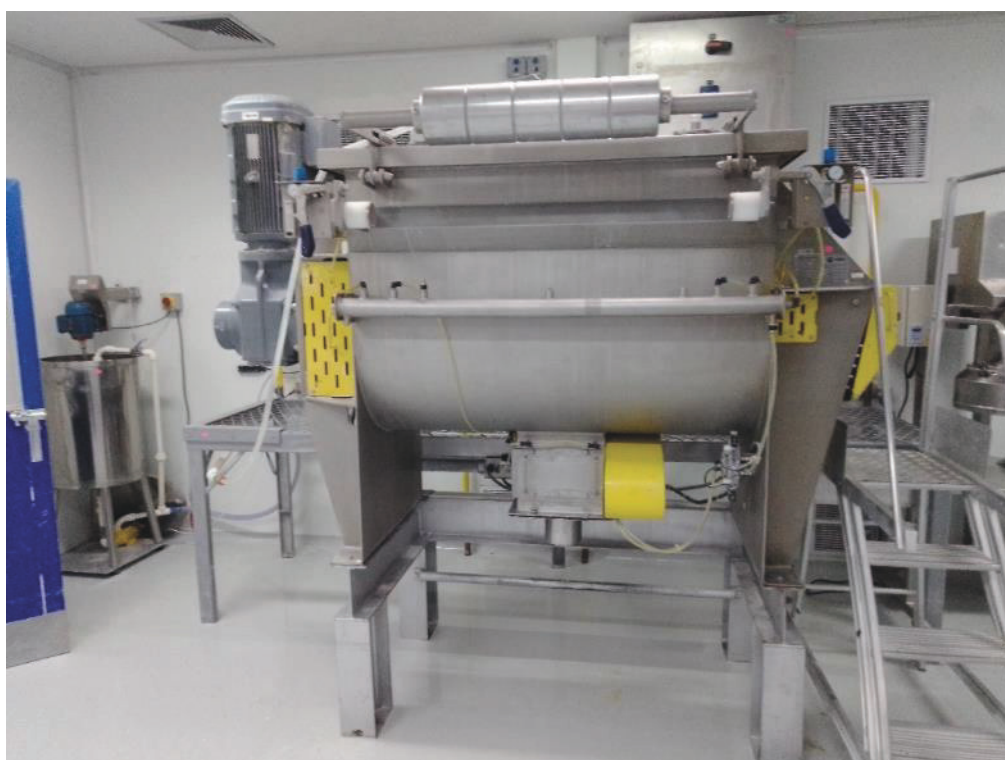
ITEM 1,582 - MISTURADOR HORIZONTAL EM INOX EIRICH LINHA OPTMABLEND FPB20 500 L
