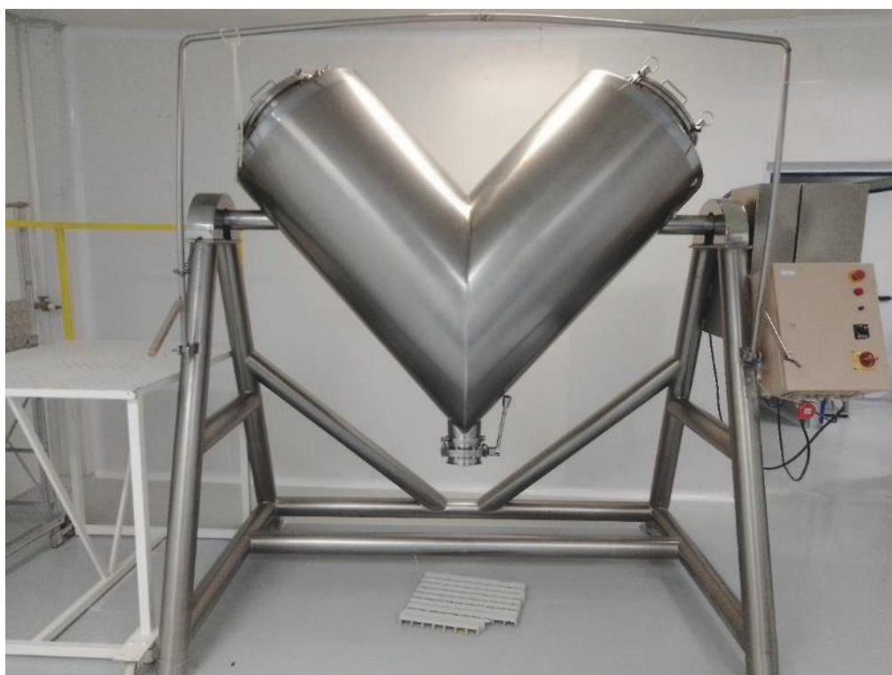
ITEM 1,598 - MISTURADOR "V" BIASINOX EQUIP. 7330P87 500 Kg
