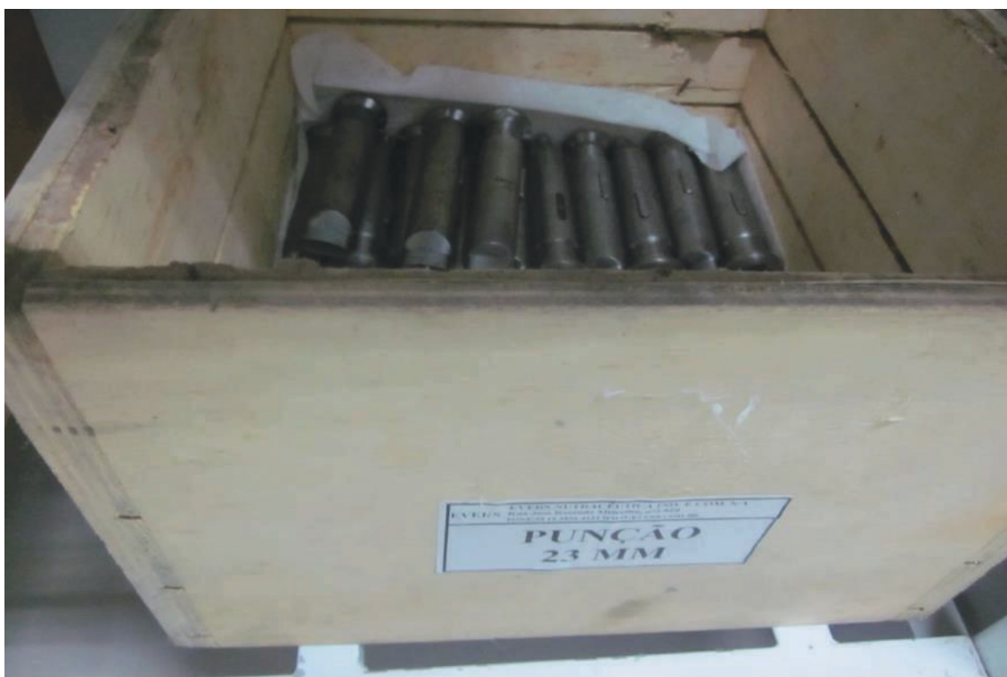
ITEM 2,176 - JOGO DE PUNÇÕES E MOLDES EM INOX PARA COMPRIMIDO OVAL 23 MM
