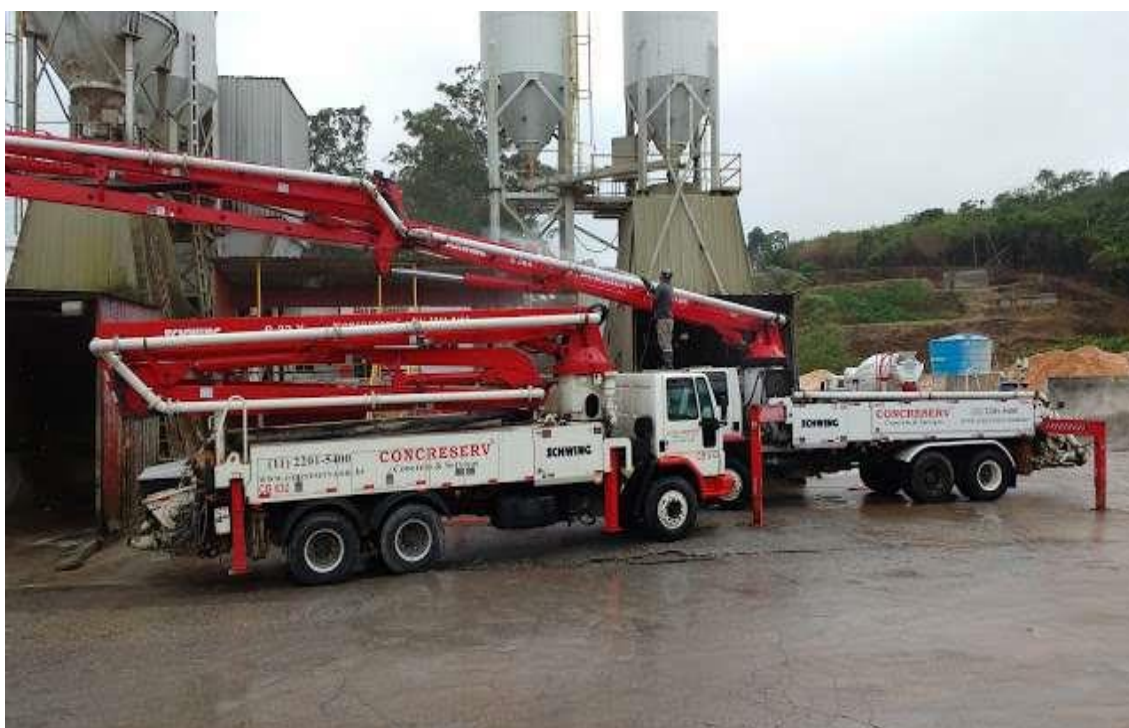
Foto: Caminhão Ford Cargo 2628e + Implemto Bomba Lança 36m Schwing Stetter
